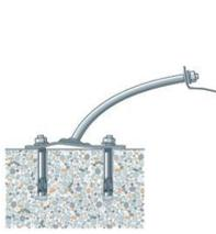
progetto 12 kN = a seguito della prova il dispositivo presenta deformazioni plastiche
