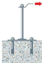
*progetto 12 kN = a seguito della prova il dispositivo non presenta deformazioni*
